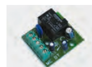
D111761 – ME BT Плата для 12/24В-электрического замка для устройств bt.
